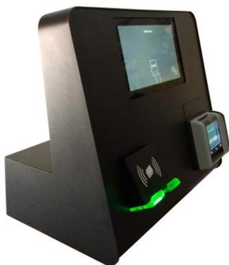
Die neue Desk-Ladestation auf Basis des LeX-Converters vereint modernste RFID- und Netzwerktechnologie mit hoher Sicherheit und einfachem Handling bei höchster Flexibilität.
